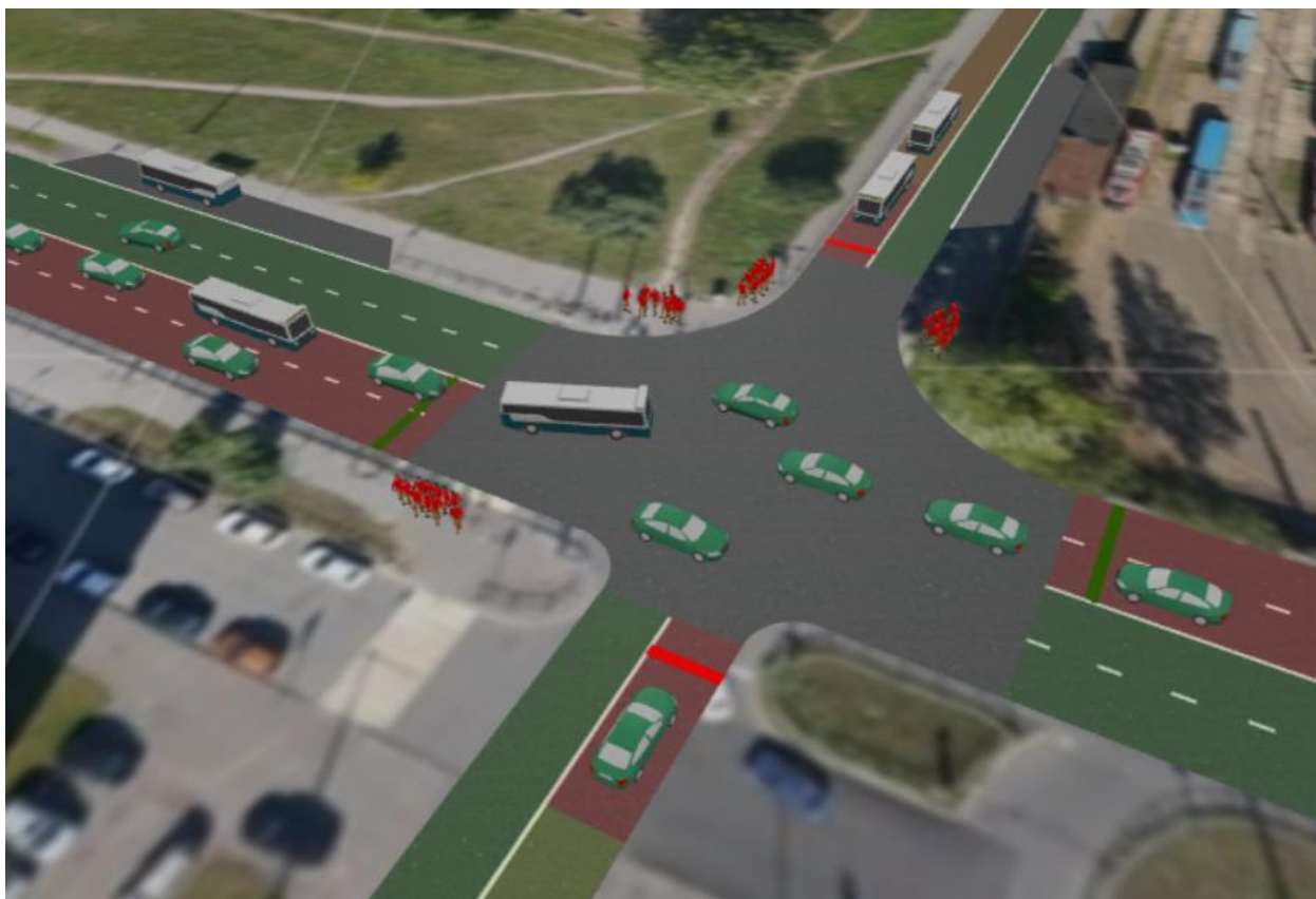
Рис. 2. 3D-анимация симуляции модели перекрестка в AnyLogic
