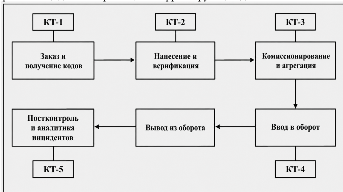
Рис. 2. Жизненный цикл кода Data Matrix у импортера и производителя
