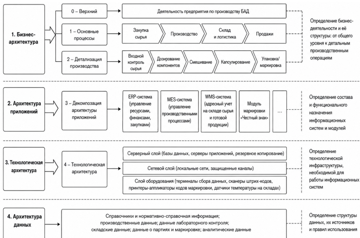
Рис. 1. Декомпозиция ИТ-архитектуры предприятия по производству БАД
