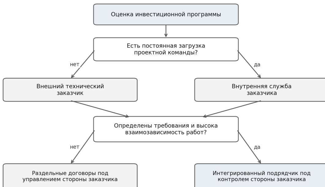
Рис. 1. Последовательность выбора организационной и подрядной конфигурации проекта
